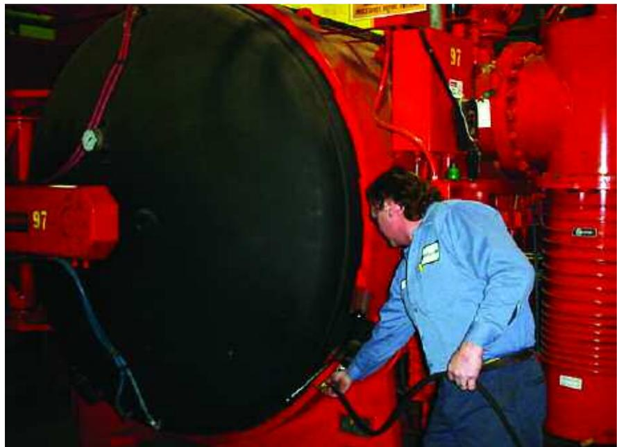
*Leak checking a door assembly*
